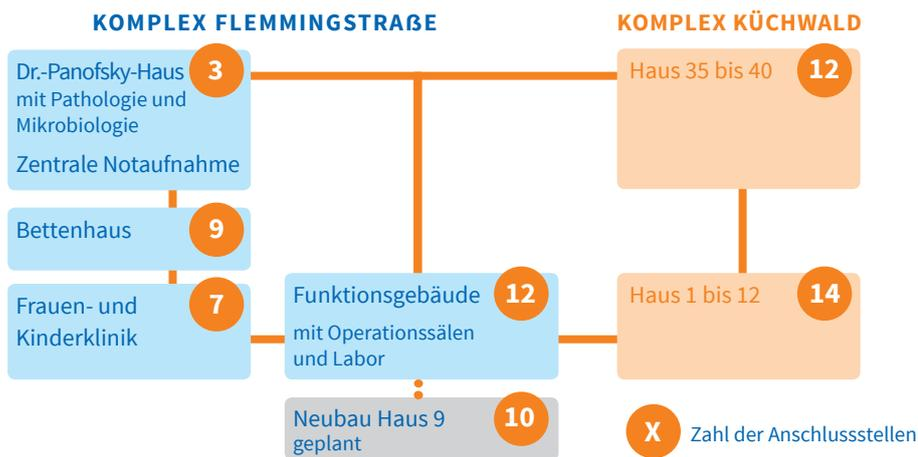
Von der Notaufnahme über das Labor bis zu den Pflegestationen und der Zentralapotheke – 57 verschiedene Krankenhausabteilungen sind aktuell an die Rohrpost angeschlossen. Die längste Verbindung, die eine Büchse während einer Sendung zurücklegen kann, beträgt rund 1,6 km zwischen Haus 35 im Küchwald und Haus A der Frauen- und Kinderklinik.
