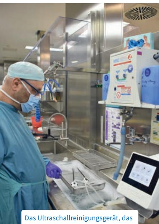
Das Ultraschallreinigungsgerät, das Tino Grenda hier bedient, ist angeschafft worden, um die Instrumente aus der Robotik-Chirurgie wieder aufzubereiten zu können.
